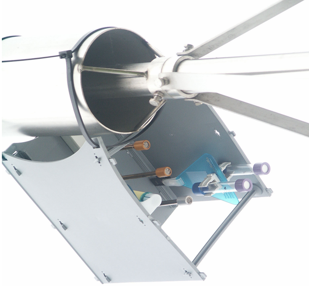
Slika 1. Ohišje z difuzivnimi vzorčevalniki
