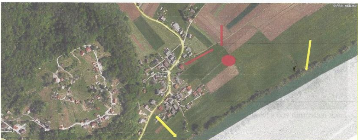
Zemelj, rdeča-smer izteka meteornih vod s fekalijami in domnevno mesto pronicanja, rumena-predlog odvzema vzorcev
